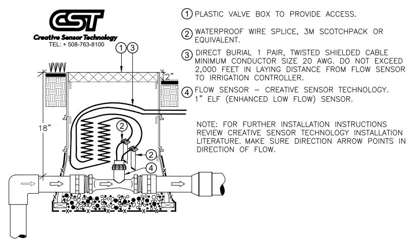
NO STRAIGHT PIPE DISTANCES ARE REQUIRED UPSTREAM OR DOWNSTREAM OF THE ELF SENSOR. MAKE SURE THE SHORTER, DISCHARGE, END OF THE SENSOR IS ON THE DOWNSTREAM SIDE.
